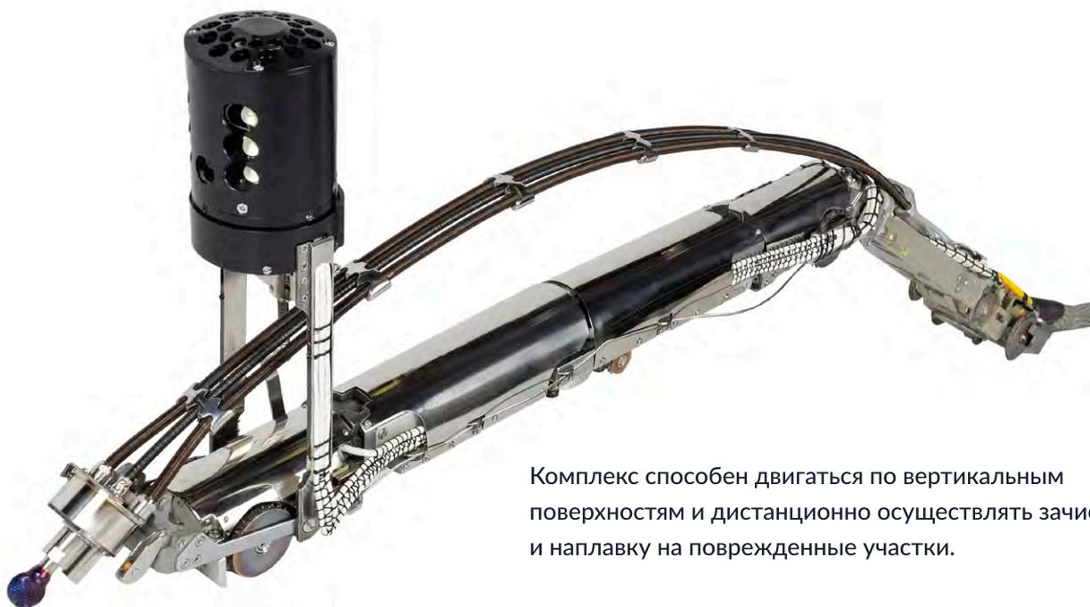
Комплекс способен двигаться по вертикальным поверхностям и дистанционно осуществлять зачистку и наплавку на поврежденные участки.
